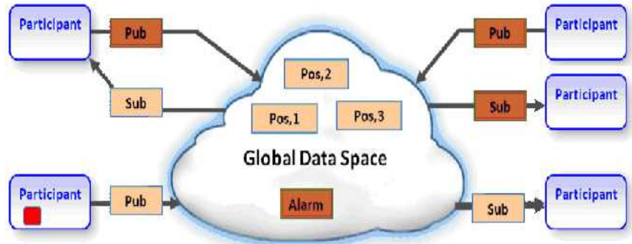
Fig. 3. Modelo simplificado de comunicaciones ofrecido por el API de DDS
