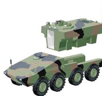
Fig. 1. Boxer 8x8 (ARTEC), mostrando claramente los módulos de conducción y de misión. El módulo de conducción está ocupado por el conductor y el jefe del vehículo y el módulo de misión es intercambiable. ( www.artec-boxer.com )
