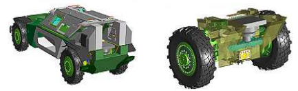
Fig. 3. Izquierda: vehículo GeFaS en configuración 4x4. Derecha: módulo correspondiente a un eje del GeFaS, donde todos los ejes son motrices e independientes. ( www.rheinmetall-detec.de )
