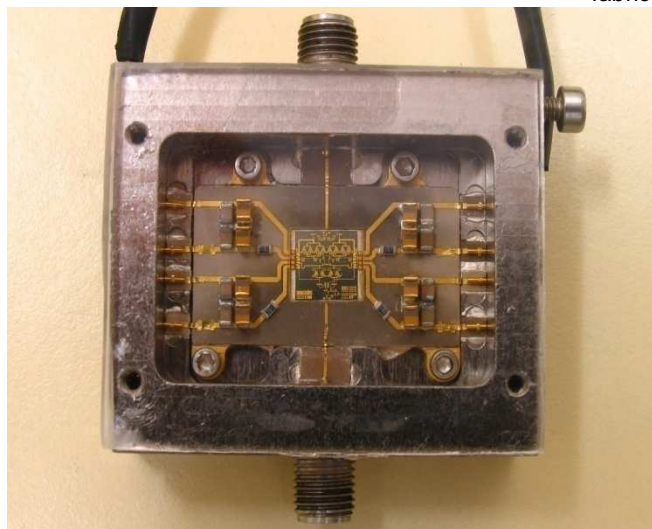
Fig. 1. Amplificador de banda ancha (2-6 GHz) de 20 W (Proyecto KORRIGAN).
