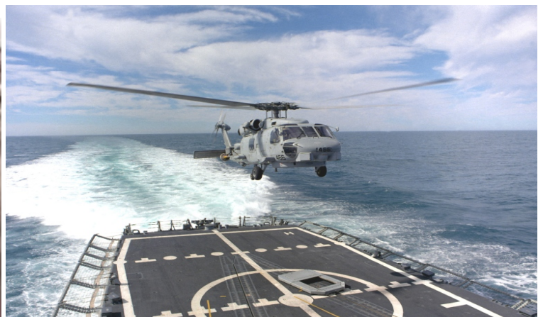
Fig. 3. Helicóptero aterrizando empleando sistema RAST. (Ref. http://www.ausairpower.net/Seahawk-RAST-2.jpg )
