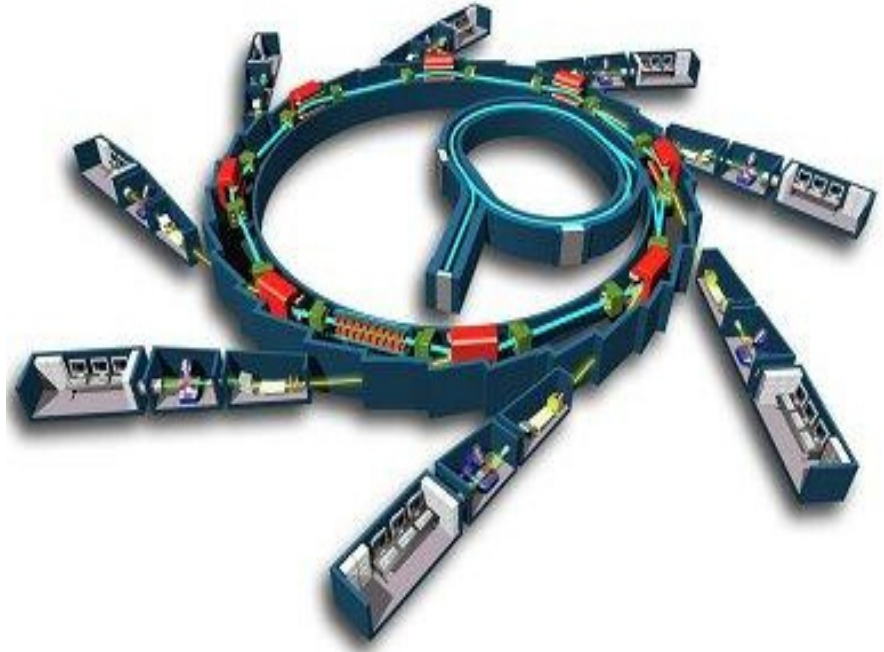
Fig. 1. Esquema de la disposición de las líneas de haz en un sincrotrón.
