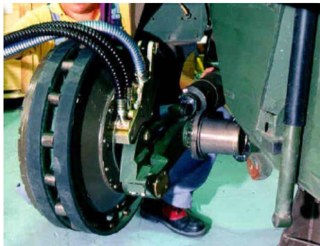
Fig. 2. Motor en cubo de rueda (MCR) integrado en el chasis de un vehículo blindado. Se observan las conexiones flexibles para alimentación, refrigeración y circuito eléctrico.
