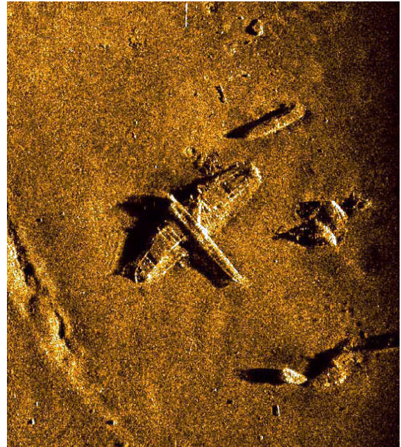
Fig. 4. Imagen SAS de un hidroavión Heinkel He-115 de la Segunda Guerra Mundial. (Imagen cortesía de la Real Marina Noruega).
