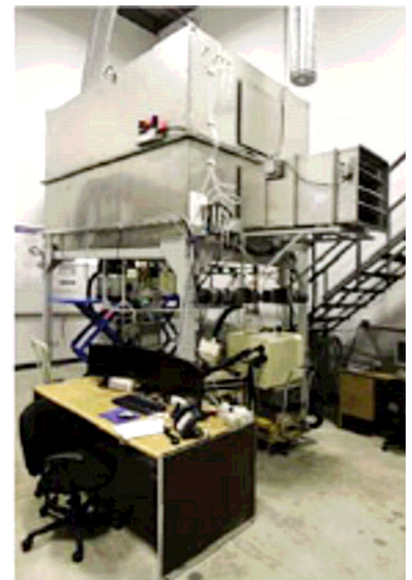
Fig. 1. Cámara de evaluación de detectores de bioaerosoles de Dycor Technologies.
