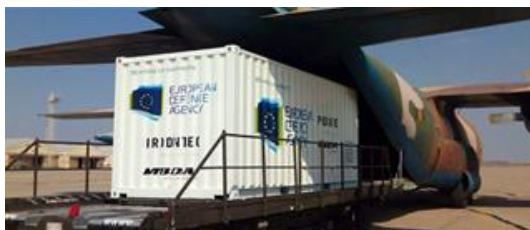
Fig. 1. Prototipo de laboratorio de fabricación aditiva desplegable y aerotransportable (EDA).
