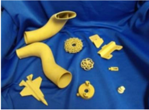
Fig. 2. Piezas plásticas obtenidas por FDM (Idonial).
