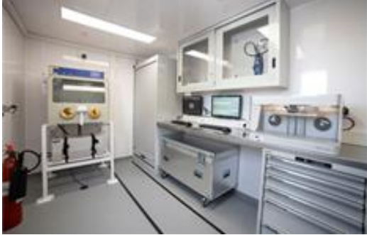
Fig. 4. Equipos instalados en un laboratorio de fabricación aditiva desplegable (EDA).
